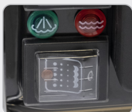
Attivazione caldaia, presa vapore 6 bar - 7P e spie luminose VAPORE PRONTO MANCANZA ACQUA in caldaia
