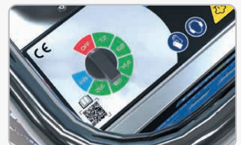
Interrupteur de régulation de puissance
