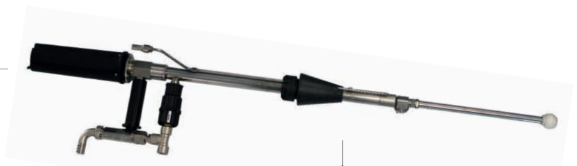
Lancia con testina rotante per botti da Ø730mm con vapore, aspirazione e acqua ad alta pressione da utilizzare con tubo bacchus e tubo acqua ad alta pressione High pressure cleaning rod for barrels Ø730mm with steam, vacuum and high pressure water functions to be used with bacchus hose and high pressure water hose
